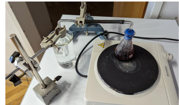
Abbildung 1: Destillation einer farbigen Kochsalzlösung
