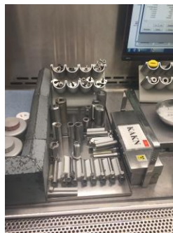
Bleihüllen für Applikationsspritzen
