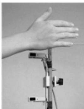
Auf einem Stativ waren zwei Reflexlichtschranken im Abstand von 15 cm montiert, die über ein Messinterface an einen PC angeschlossen waren. Durch eine einfache Abwärtsbewegung der Hand an den Lichtschranken vorbei wird die Geschwindigkeitsmessung durchgeführt.
