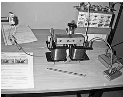
Induktion Der Motor dreht sich nur kurz beim Schließen. Das Kupferblech sinkt und beim Öffnen des Schalters, wird in der linken Spule Spannung induziert
