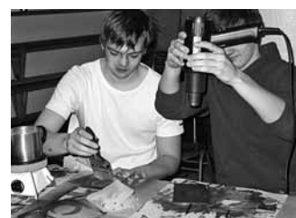
Magnetbilder mit Eisenfeilspänen sichtbar machen und mit Wachs fixieren
