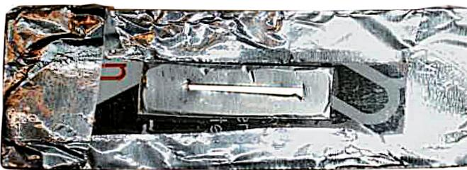
8. Schneide ein langes Stück Karton mit den Maßen 3,3 cm x 7 cm aus. Schneide mit einem Stanleymesser ein Fenster hinein (3 cm x 2 cm). Nun lege ein Stück Alufolie über den Spalt und klebe es in der Mitte mit Klebeband fest. Schneide mit dem Stanleymesser einen hauchdünnen Spalt (~1 mm Breite) in die Folie. Klebe über die Folie Klebeband, sonst reißt die Alufolie schnell. Nun kannst du den Spalt in die Öffnung schieben.
