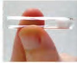
Füllen Sie ein Reagenzglas wie in der Abbildung mit Citronensäure. Geben Sie vorsichtig (klebt an der Wand!) einen Tropfen Glycerin dazu. Nehmen Sie eine Holzklammer als Halter und erhitzen Sie die Mischung über dem Brenner. Rühren Sie mit dem Holzstab dabei um! Die Mischung wird über dem Brenner erhitzt, bis die Stoffe schmelzen und zu einem zähen Produkt reagieren.
