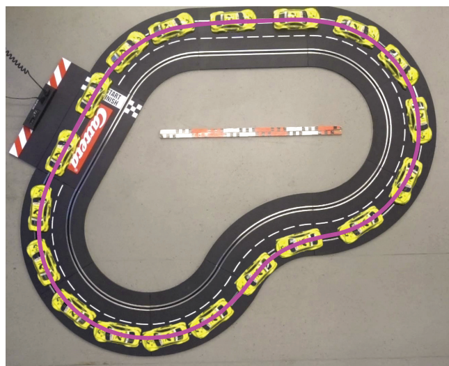
Abbildung 1: Stroboskopbild eines fahrenden Spielzeugautos und dessen Bahnkurve (rosa)
