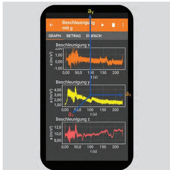
**Abbildung:** Beschleunigungsmessung beim Start eines A320-200 (Rohdaten der Messungen der Abbildungen 2b und 4). Eingezeichnet sind die Messachsen der Sensoren: Die y-Achse zeigt in Fahrtrichtung des Flugzeugs. Die z-Achse steht senkrecht auf dem Sitz.
