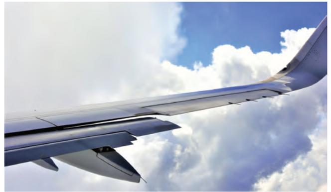
**Abbildung 10:** Mit Auftriebshilfen (Start- und Landeklappen) kann der Auftriebsbeiwert vergrößert werden.
