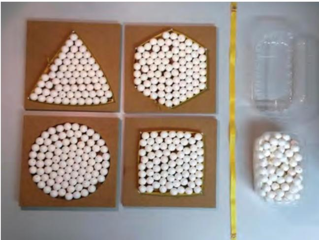
**Abbildung 3:** Modellversuch zur Erkenntnis der optimalen Volumennutzung verschiedener geometrischer Formen mit Druckband, Kugeln und leerer Zählbox
