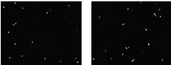
Abbildung 6: Alphastrahlung (links) führt zu eher punktförmigen Spuren. Betastrahlung (rechts) auch zu längeren Spuren.
