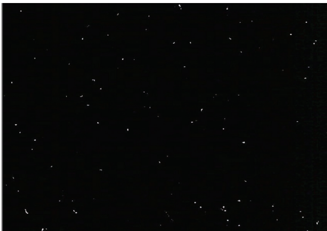
Abbildung 1: Webkameras lassen sich auch als Detektor für ionisierende Strahlung nutzen.
