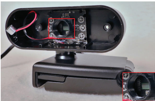
Abbildung 3: Günstige Kameras lassen sich häufig leicht aufschrauben und verändern. In der Bildmitte ist der Sensor zu erkennen.
