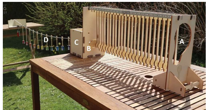
Abbildung 2: Das Holzmodell im Überblick. Der Schallimpuls wird von der Magnetpendelkette (A) auf das Trommelfell (B) und Mittelohr (C) in das Innenohr (D) übertragen.
