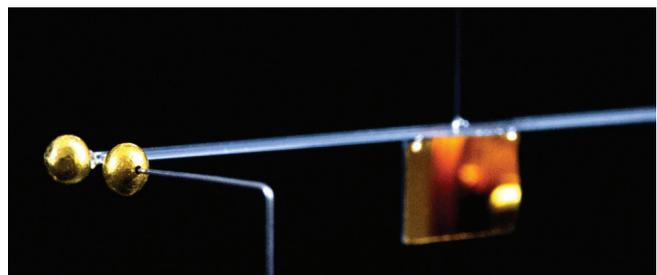
**Abbildung 3:** Gravitationspendel zur Messung kleinster Gravitationsquellen. Die Goldkugeln haben einen Durchmesser von 1mm. Testmasse (linke Kugel) und Quellmasse (rechte Kugel) müssen möglichst nahe zusammengebracht werden. Ein Goldspiegel dient zur Positionsmessung per Laser.
