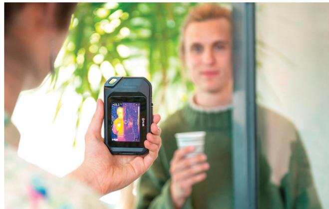
**Abbildung 4:** Ein Fenster lässt die IR-Strahlung eines menschlichen Körpers nicht durch, reflektiert aber die IR-Strahlung einer Hand und der in Richtung Fenster gehaltenen IR-Kamera.
