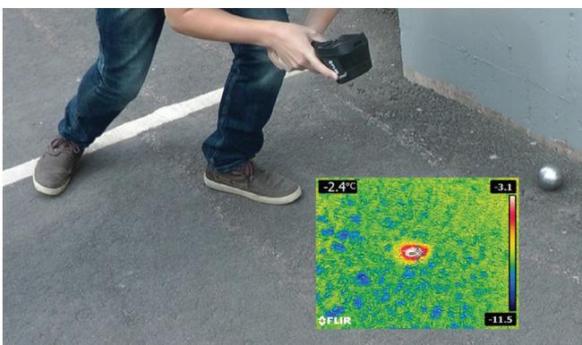
**Abbildung 1:** IR-Bild, das den Temperaturanstieg beim Aufprall einer Stahlkugel auf Asphalt zeigt.
